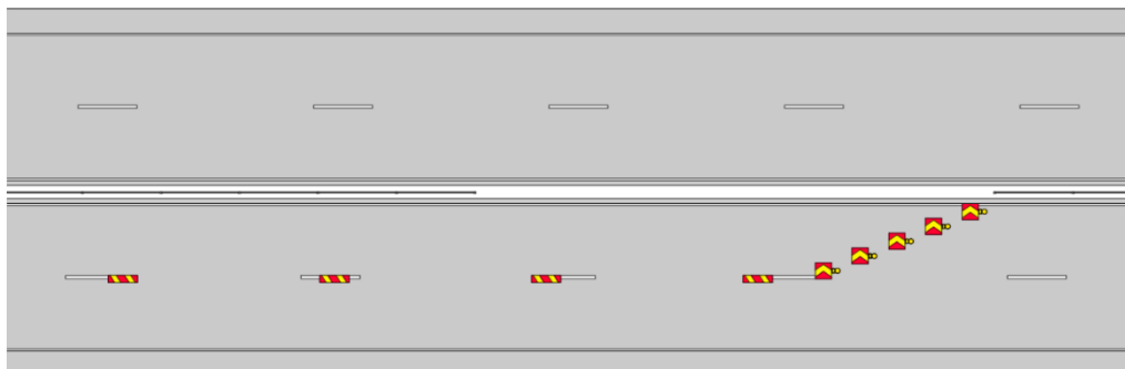
Figur 10.2. Utmärkning med X1 Markeringspil kompletterad med lyktor i funktion rinnande ljus när överledning går över ett körfält.
