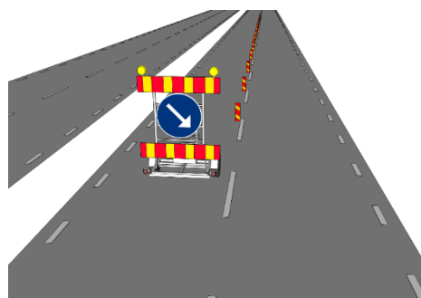
Figur 10.15 Utmärkning med X2 Markeringsskärm för hinder kompletterat med lyktor SIG18 Gult blinkande ljus för påkallande av särskild försiktighet samt D2 Påbjuden körbana.
